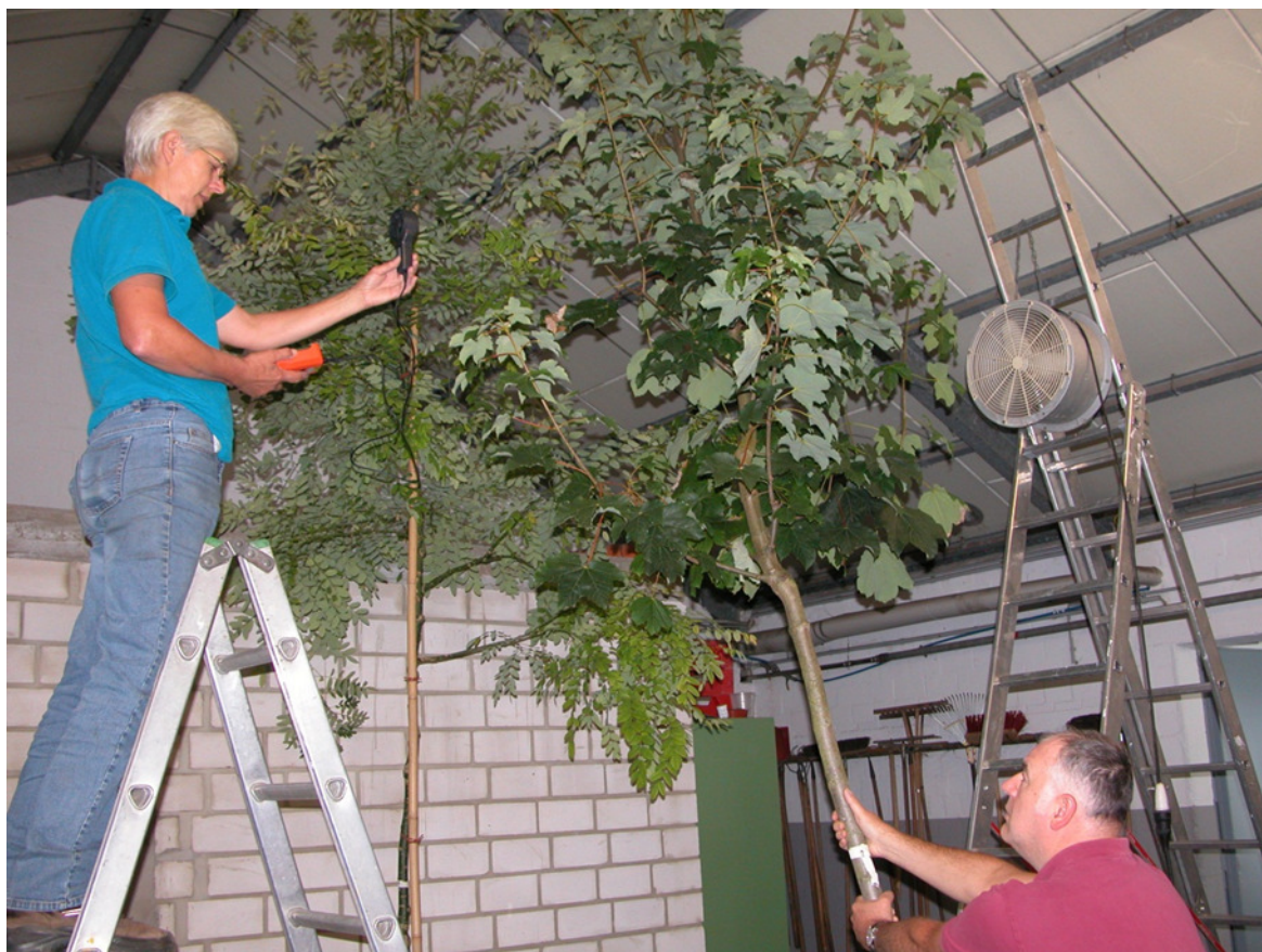
Abb. 1: Messung der Winddurchlässigkeit verschiedener Baumarten mit Anemometer
